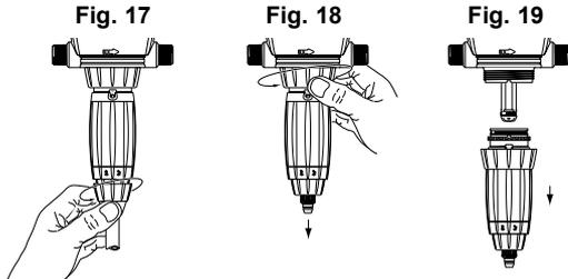
**NETTOYAGE ET REMONTAGE DU CLAPET D'ASPIRATION**
