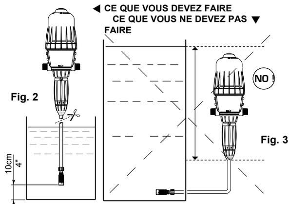
En aucun cas le niveau de la solution ne doit être au-dessus de l'entrée d'eau dans le DOSATRON (afin d'éviter tout siphonnage) (Fig. 3).
