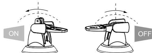
Le DOSATRON peut être équipé, dans sa partie haute, d'une fonction by-pass (matériel en option) :
